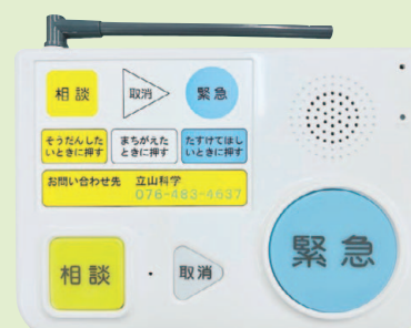
緊急通報装置
